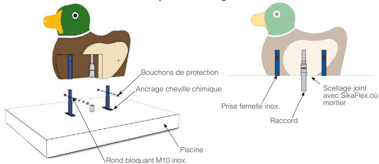
Nous avons conçu ces éléments pour un assemblage sur chantier le plus rapide et simple possible, sans outils ni équipements spéciaux.
